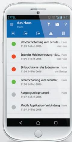
Es ist sinnvoll, die Applikation VERSA CONTROL bei der Installation des Alarmsystems zu konfigurieren, umso mehr, dass es sehr einfach ist. Es reicht zwei Parameter einzugeben: MAC und ID-Nummer (sie können sowohl vom Bedienteil – auch von der Benutzerebene, sowie auch im Programm DLOADX abgelesen werden). Außerdem bei der Konfiguration der Applikation kann man die Filter einstellen. Dadurch definiert man, über welche Ereignistypen man informiert werden will.
