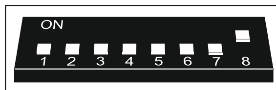
Abb. 13. Einstellung der DIP-Schalter im Modul ACU-120 / ACU-270.
