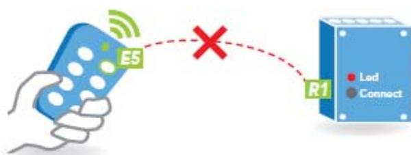
**A-3b** Unterbrechen der Verbindung des Tasters eines Senders mit zwei von drei Empfängern. Nur einer der drei Empfänger bleibt verbunden.
