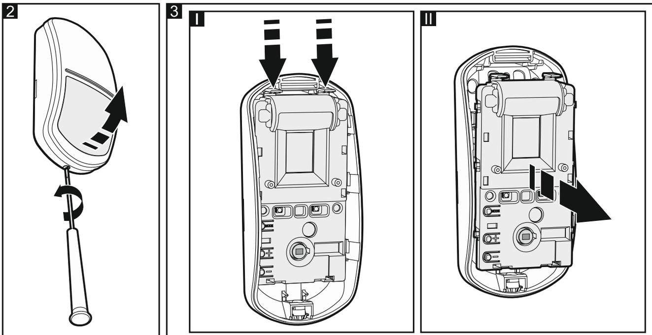
3. Montieren Sie die Batterie und registrieren Sie den Melder im Funksystem (siehe: Anleitung für das ABAX 2 / ABAX Funkbasismodul oder Errichteranleitung für die Alarmzentrale INTEGRA 128-WRL). Der Aufkleber mit der Seriennummer, die bei der Registrierung des Melders im System anzugeben ist, befindet sich auf dem Elektronikmodul.
