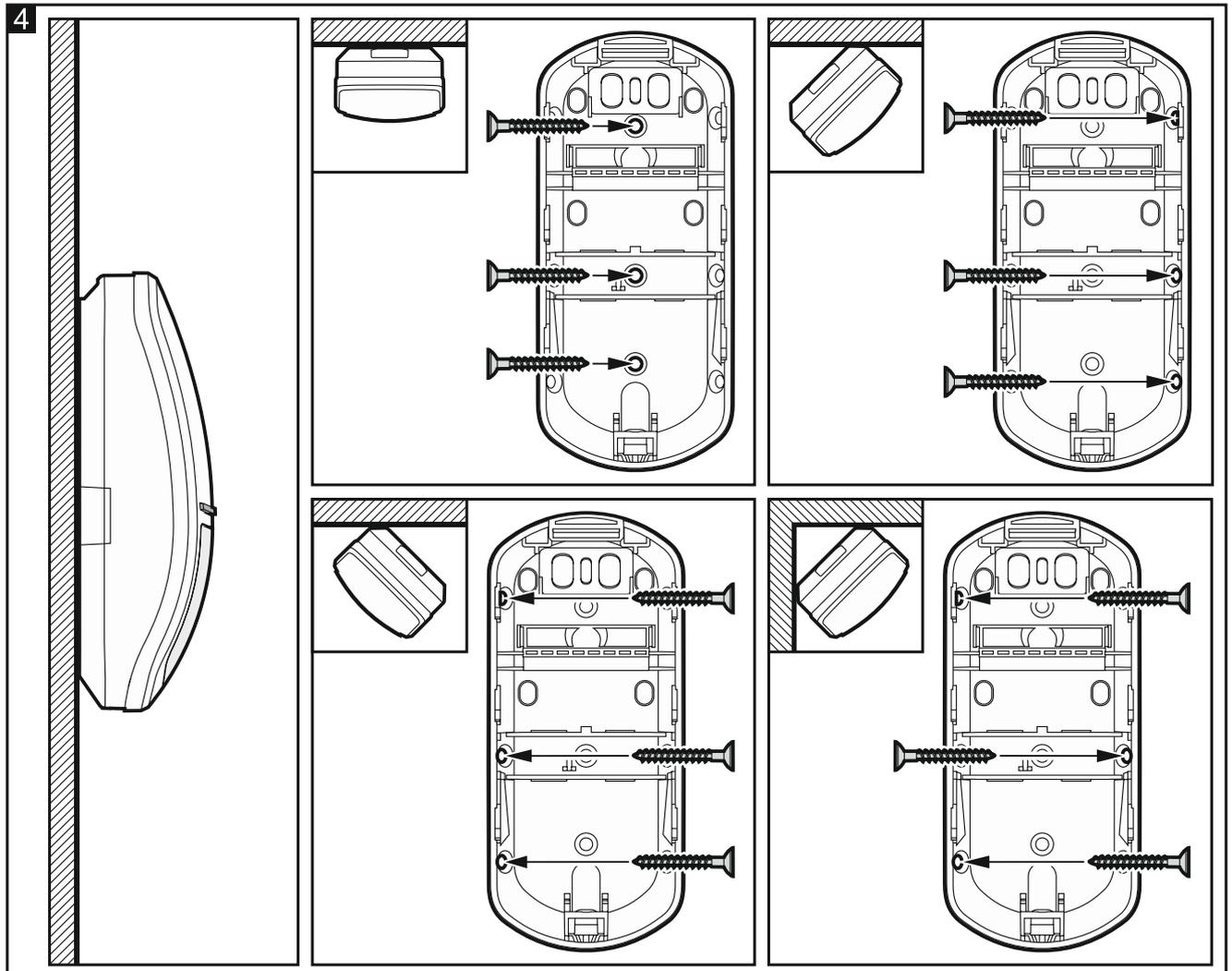
9. Fertigen Sie die Öffnungen für Schrauben im Gehäuseunterteil.
