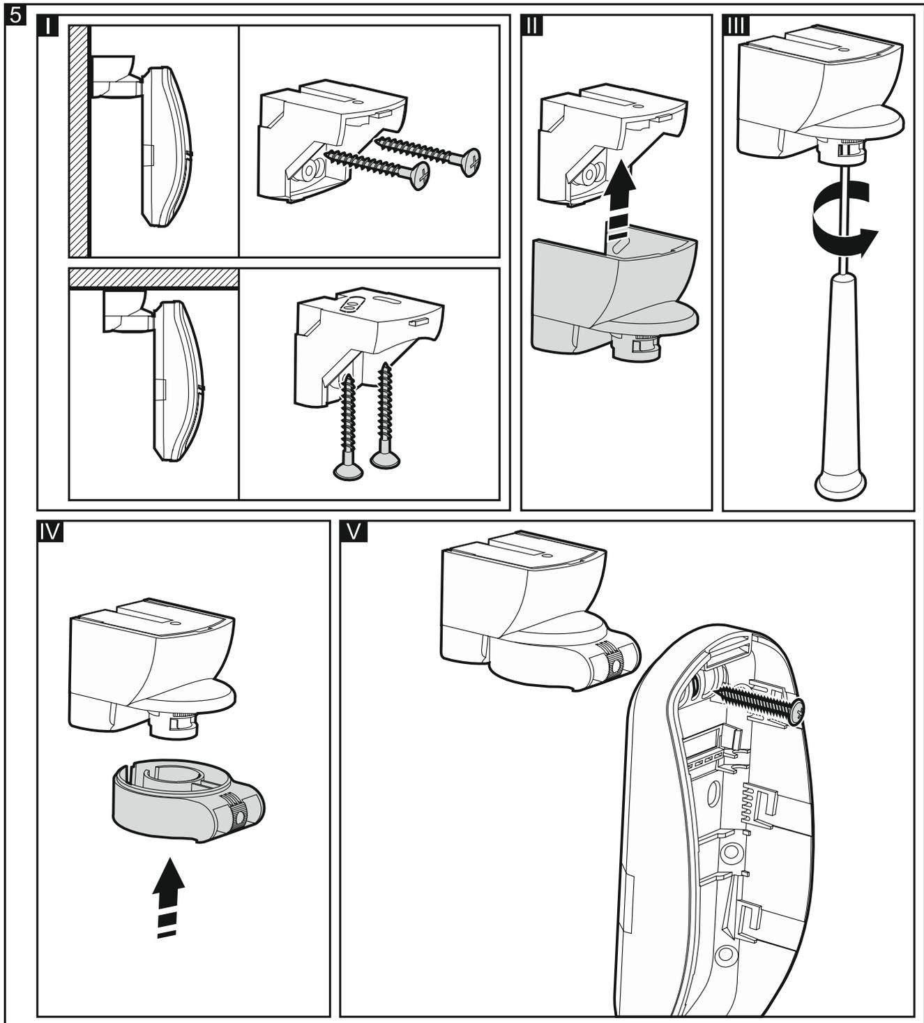
11. Befestigen Sie das Elektronikmodul im Gehäuse.
