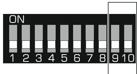
Abb. 2. Schalter zur Bestimmung des Betriebsmodus des Funkbasismoduls.
