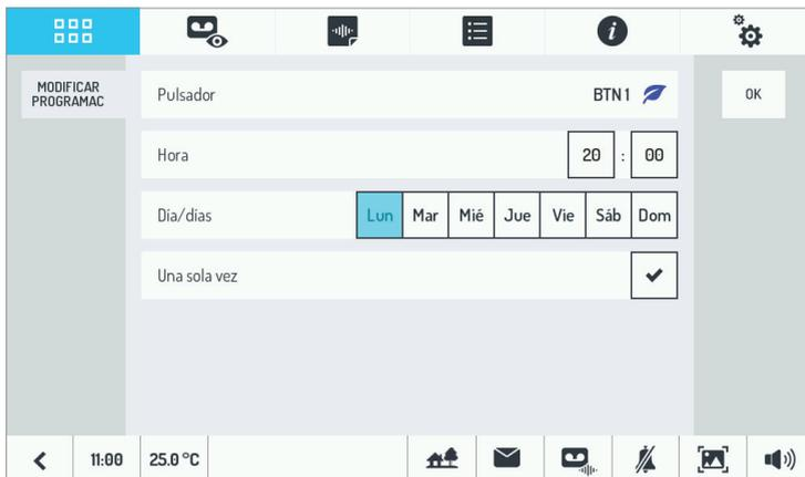
Tocar la línea 'Pulsador' para cambiar el pulsador a programar, introducir la hora y los días de la semana en los que se quiere ejecutar la programación y si se quiere que se ejecute solamente una vez. Guardar las configuraciones tocando  .
