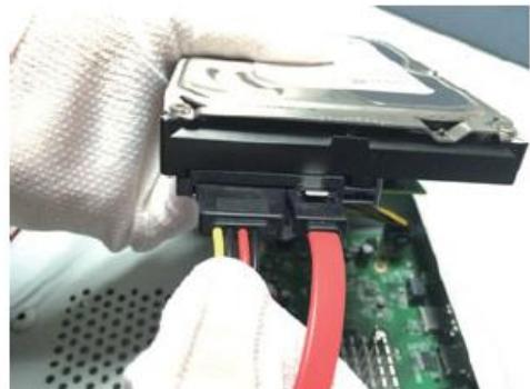
4. Ziehen Sie die Festplattschrauben an der Unterseite des NVR-Gehäuses fest, bringen Sie die obere Abdeckung an und befestigen Sie sie mit Schrauben
