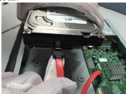
3. Connectez une extrémité du câble d'alimentation du disque dur à l'interface de la carte mère NVR, et l'autre extrémité se connecte au disque dur.
